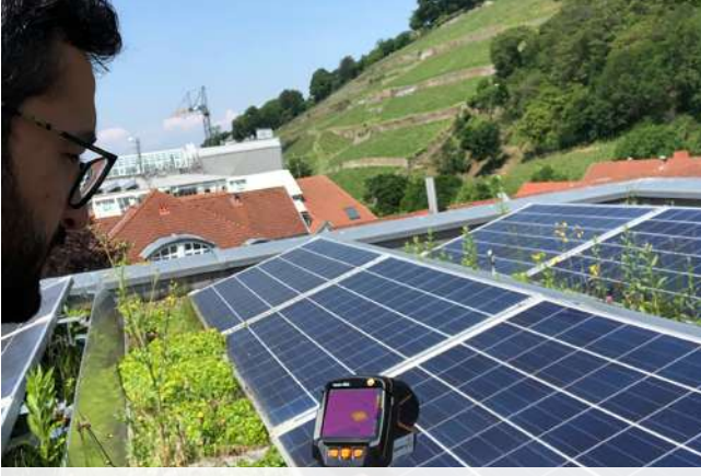
Resim 3: testo 883 termal kamera, bir PV sistemini incelemek için kullanılıyor.
